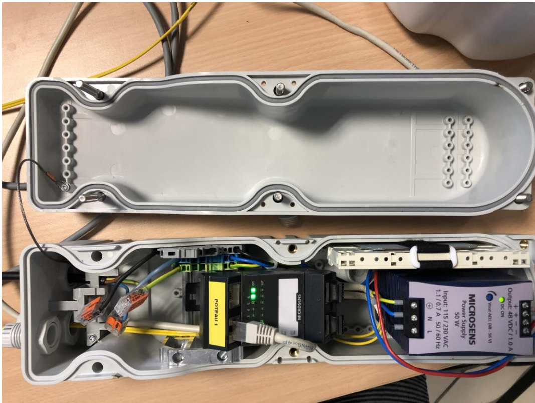
Figure 23 : Mini commutateur microsens dans un boîtier de protection
